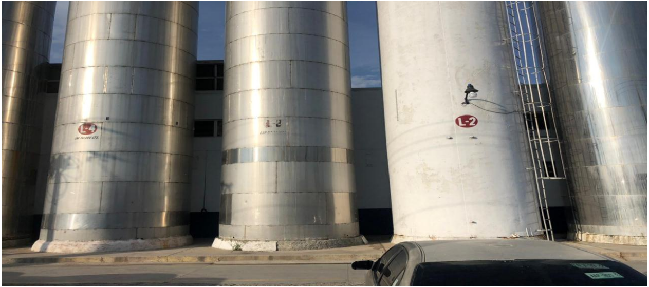
Tanques donde en cada uno se introduce la leche, agua y suero para hacer la pasteurización.
